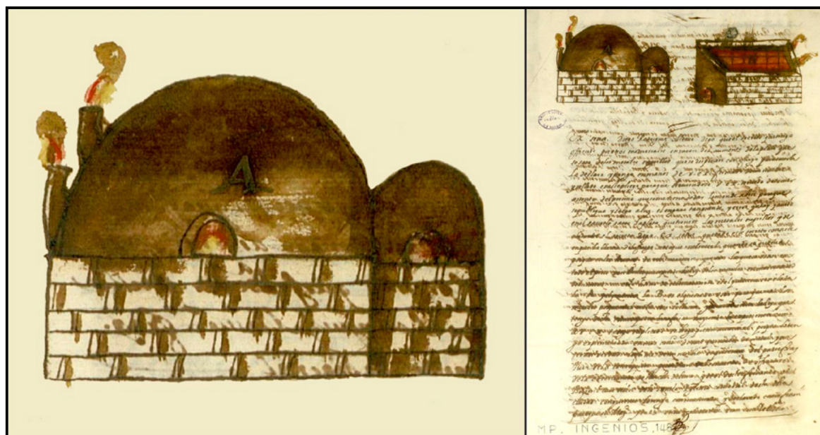
Figura 2. Dibujo de horno de reverbero en el documento de 1635 (AGI/27.14 MP-Ingenios, 148, r).
