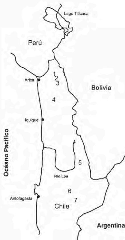
Figura 1. Ubicación canales de desagüe, conducción y trasvase, norte de Chile: (1) trasvase Jurasi-Tilivire, (2) trasvase Aroma-Tilivire, (3) trasvase Vilasamanani-Socoroma, (4) canal desagüe Tarapacá-Duplisa/Iluga, (5) trasvase Topain, (6) canal desagüe río San Pedro-Beter, (7) canales conducción y trasvase Socaire.
